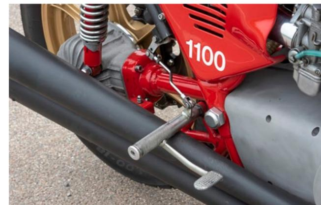
Der Bremshebel ist – wie der Schalthebel links – mit der drehbar gelagerten Fußraste verschweißt, aber wegen des Auspuffs zu hoch positioniert
