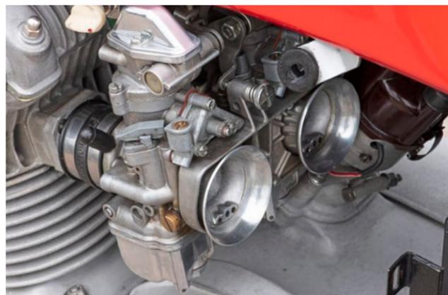
Die Batterie mit den vier Dell'Orto PHF 30 BV-Vergasern offenbart trotz Beschleunigerpumpen leichten Schluckauf
