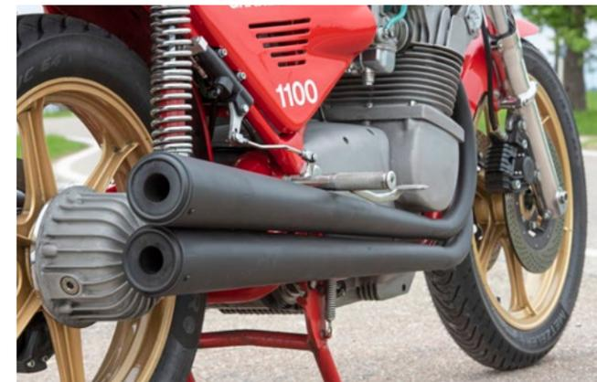
Nur diese, erst 2005 aufgebaute Grand Prix hat gerade verlaufende Schalldämpfer und den mächtigen Kardan. Die 1100 von 1978 hatte Kettenantrieb
